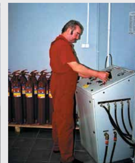
Wykonywanie prób ciśnieniowych zbiorników
