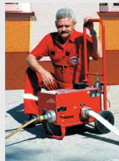
Badanie węży hydrantowych
